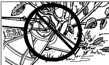
**La lame à herbe 8 dents**, est conçue pour le gazon, les débris et les mauvaises herbes épaisses de 19 mm (3/4 po) de diamètre. **NE PAS** utiliser cette lame pour tailler des broussailles ou des arbustes.
