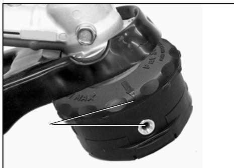
3. Insérer une extrémité de la ligne de coupe dans un œillet et pousser la ligne jusqu'à mi-longueur à travers la tête de coupe.
