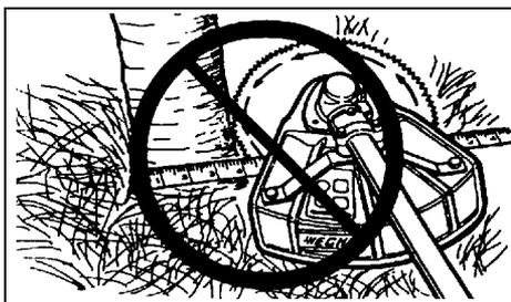
**La lame de défrichage à 22 dents**, est conçue pour la coupe de broussailles denses et arbrisseaux jusqu'à 64 mm (2 1/2 po) de diamètre.
