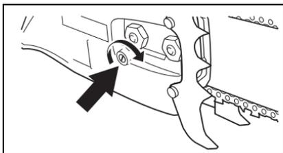
4. Serrer les écrous du guide-chaîne, le nez du guide étant maintenu relevé pour éliminer le jeu.
