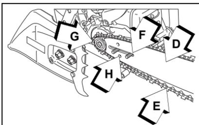
5. Montez la barre de guidage (D) sur les goujons (F) et glissez-la vers le pignon du tambour d'embrayage (G) pour faciliter l'installation de la chaîne de scie (E). Installez la chaîne de scie autour du pignon du tambour d'embrayage et de la barre de guidage comme indiqué, avec les couteaux au-dessus de la barre de guidage vers l'avant.
