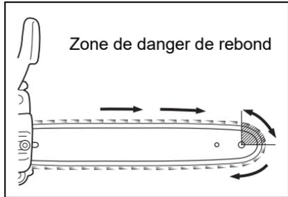
2. Maintenez fermement la scie avec les deux mains, la main droite sur la poignée arrière et la main gauche sur la poignée avant, lorsque le moteur tourne.
