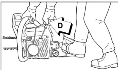
Remarque: Ne pas tirer le câble du démarreur jusqu'à la position la plus haute possible. Ne pas laisser la poignée du démarreur revenir rapidement contre le boîtier. Si le moteur ne démarre pas après 5 tentatives, il faut reprendre la procédure.
