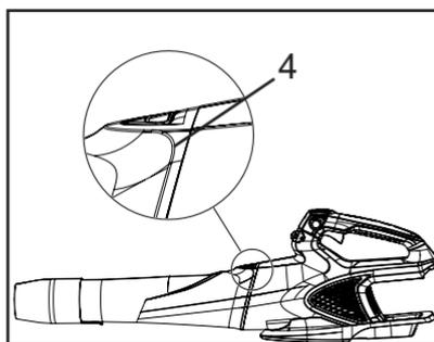
1. Raccordez la buse du concentrateur (6) jusqu'à ce que le tube (5) s'enclenche dans la buse (6).
