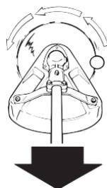
Comme le montre l'illustration, une lame tournant dans le sens contraire des aiguilles d'une montre pousse l'appareil à l'écart de l'utilisateur si le point de résistance à la coupe est du côté gauche de la lame. Si le point de résistance à la coupe est du côté droit de la lame, l'appareil est poussé vers l'arrière en direction de l'utilisateur. Dans les deux exemples, la force réactive est dans la direction opposée à la rotation de la lame au point de contact où la résistance se produit.
