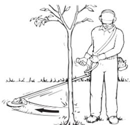
Pour dégager une lame prise dans la coupe, coupez l'appareil et soutenez le taille-bordure ou la débroussailleuse pour libérer la lame de toute tension. Poussez l'arbre à l'écart du point d'entrée de la coupe pour ouvrir celle-ci, puis tirez la lame directement hors de la coupe dans un mouvement en ligne droite. Faites preuve de prudence lorsque vous relâchez l'arbre pour éviter d'être frappé par son rebond ou sa chute.
