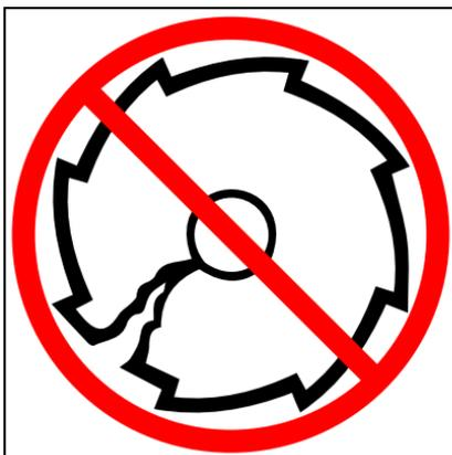
Lors de l'affûtage d'une lame, toujours éliminer la même quantité de matériau de chaque dent pour maintenir l'équilibre. Une lame mal équilibrée est dangereuse, car elle cause des vibrations risquant de la briser.
