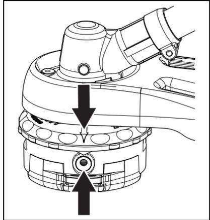
3. Insérer une extrémité de la ligne de coupe dans un œillet et pousser la ligne jusqu'à mi-longueur à travers la tête de coupe.
