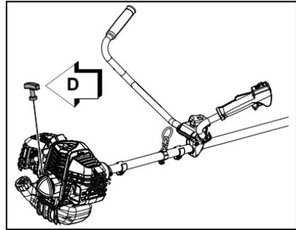
Remarque: Si le moteur ne démarre pas après cinq tractions du cordon, utiliser la procédure de démarrage à froid.
