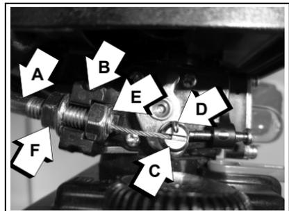
3. Tournez le dispositif de rétention du câble (D) dans le sens des aiguilles d'une montre pour sécuriser le câble dans sa fixation.
