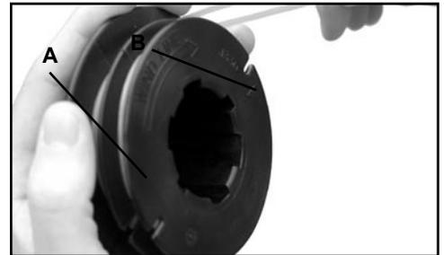
3. Aligner les chevilles du mécanisme intérieur (A) sur les encoches de la bobine et installer la bobine (B) sur le tambour. Ne pas appuyer sur la bobine. Tourner la bobine dans le sens antihoraire jusqu'au déclic de la cheville de verrouillage dans le trou de la bobine (C).
