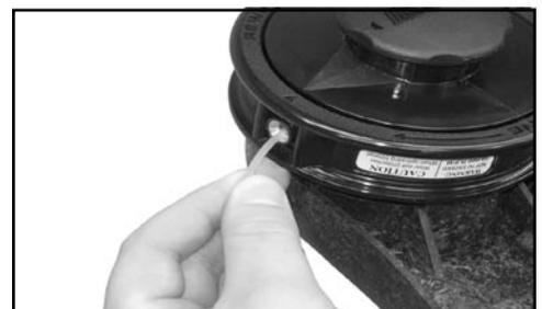
6. Maintenir fermement le tambour et tourner la bobine dans le sens horaire pour enrouler la ligne sur la bobine.
