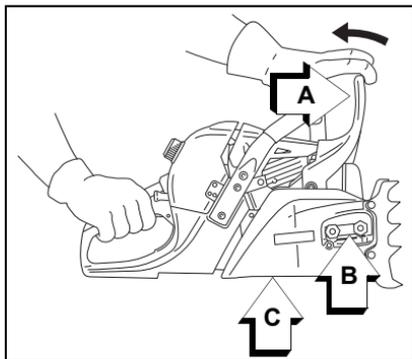
4. Retirer le guide-chaîne (D) et la chaîne de scie (E) si nécessaire.
