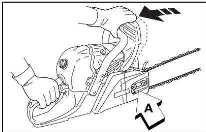
3. Maintenir le nez du guide relevé et tourner la vis (A) de réglage dans le sens horaire de manière à ce qu'il n'y ait plus de jeu entre la chaîne et le guide.
