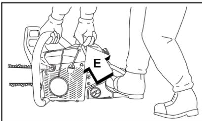
Remarque: Ne pas tirer le câble du démarreur jusqu'à la position la plus haute possible. Ne pas laisser la poignée du démarreur revenir rapidement contre le boîtier. Si le moteur ne démarre pas après cinq tentatives, il faut reprendre la procédure.
