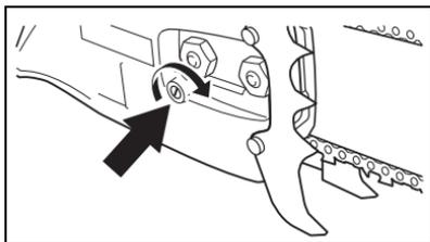
4. Serrer les écrous du guide-chaîne, le nez du guide étant maintenu relevé pour éliminer le jeu.
