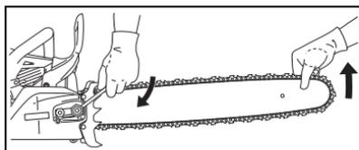
5. Engager la chaîne sur le guide à la main. Si elle est trop tendue en certains points, desserrer les fente de réglage.
