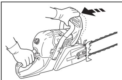
Remarque: Ne pas augmenter le régime moteur lorsque le frein de chaîne (A) est verrouillé. Autrement, les freins seront gravement endommagés.
