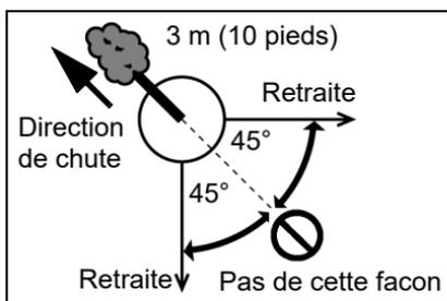
Avant de couper, dégager autour de l'arbre. La position doit être stable et il faut pouvoir utiliser la scie sans heurter le moindre obstacle. Prévoir ensuite un chemin de repli. Lorsque l'arbre commence à s'incliner, il convient de se reculer de la direction de la chute selon un angle de 45° et d'au moins 3 m pour se dégager du rebond du tronc sur la souche. Commencer la coupe du côté vers lequel l'arbre doit tomber. Découper une entaille correspondant au tiers du diamètre, voir illustration.
