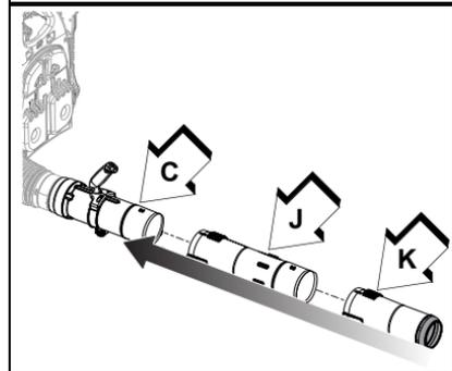
9. Insérez l'extrémité du tube (K) au tube droit (J) comme à l'étape 8.
