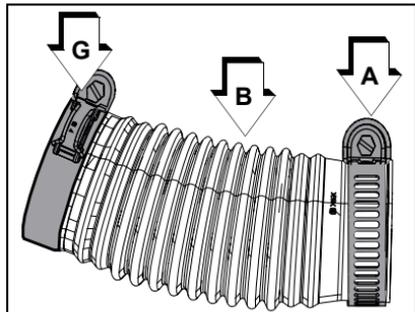
2. Insérez le fil antistatique à travers le tube flexible.
