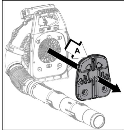
2. Installez l'insert par temps froid (B) sur le cadre au-dessus de l'admission d'air.
