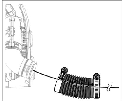
3. Insérez le tube flexible dans le coude (D) du souffleur. Placez le collier avec l'anneau de guidage du câble (G) à l'extérieur du tube flexible et serrez le collier.
