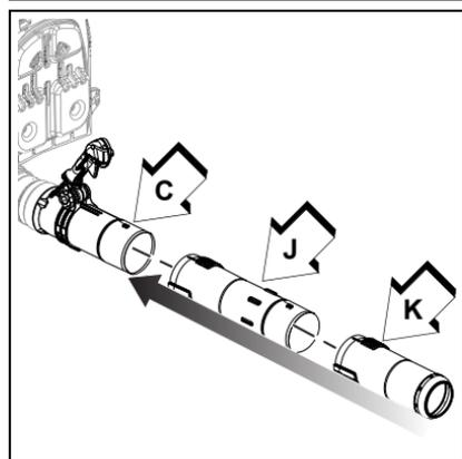
Remarque: L'utilisation du souffleur desserrera éventuellement les raccords du tube. Le système de verrouillage positif exclusif permet de serrer les tubes. Si un desserrage se produit, retirez les deux tubes droits et réinstallez selon les consignes 9 et 10.
