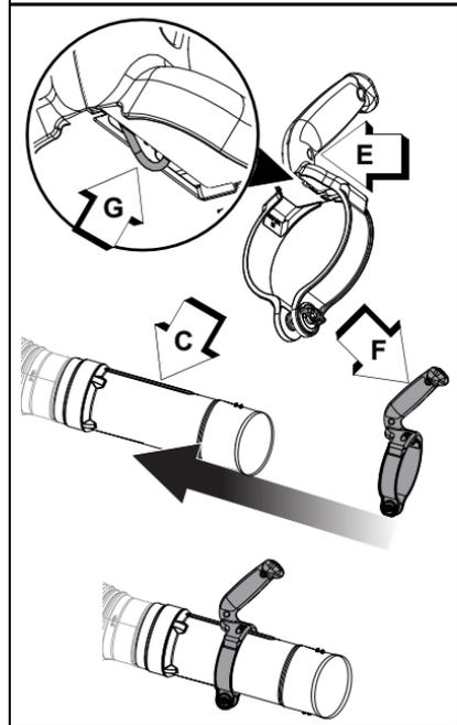
8. Insérez le tube droit (J) dans le tube articulé (C), jusqu'à ce que vous sentiez une légère résistance. Maintenez le tube articulé et tournez le tube droit selon le sens horaire, de manière à engager les ergots de verrouillage dans leurs gorges, jusqu'à ce que le raccordement soit solide. Ne forcez pas le raccordement.
