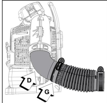
4. Placez le câble de gaz le long de l'extérieur du coude. Dévissez le bouton (H) de la poignée (E). Installez sur le tube articulé (C).
