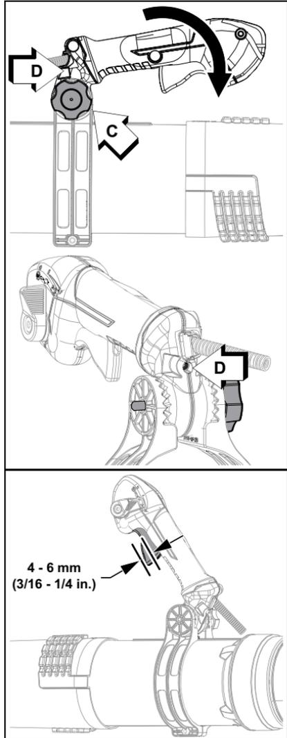
2. Tournez la vis d'ajustement (D) jusqu'à ce que le levier d'accélération ai un jeu de 4 à 6 mm (3/16 à 1/4 po.).
