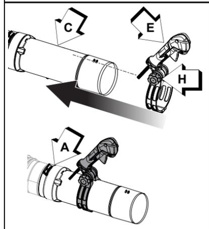
9. Insérez le tube droit (K) dans le tube articulé, jusqu'à ce que vous sentez une légère résistance. Maintenez le tube articulé et tournez le tube droit selon le sens horaire, de manière à engager les ergots de verrouillage dans leurs gorges, jusqu'à ce que le raccordement soit solide. Ne forcez pas le raccordement.
