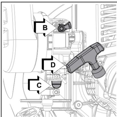
5. Si le moteur s'allume et continue de fonctionner, tirez sur la gâchette de gaz (modèle T) ou avancez la manette de gaz (modèle H) pour ramener automatiquement l'étrangleur en position de marche, puis procédez au réchauffement du moteur. Si le moteur s'allume et s'éteint, passez à l'étape 6.
