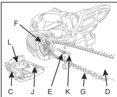
7. Installez le couvercle de la barre / embrayage (C) sur le goujon de la barre de guidage (H). Assurez-vous que la broche de réglage de tension de la chaîne (J) s'insère dans la fente de réglage de la barre de guidage (K) et que la bande de frein (L) est positionnée autour du tambour d'embrayage (M). Serrer l'écrou du couvercle de la barre d'embrayage (B) à la main.
