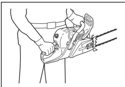
Faire démarrer le moteur, vérifier qu'il fonctionne correctement. Actionner la commande d'accélérateur pour ouvrir l'accélérateur à fond, commencer la coupe, qui devrait s'effectuer en douceur si la chaîne est bien affûtée. Peser sur la tronçonneuse à pour effet de ralentir le moteur et la coupe sera en fait plus difficile.
