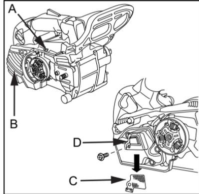
Remarque: En nettoyant des gisements de carbone, faites attention à ne pas endommager le corps catalytique (D).
