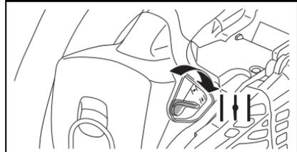
Remarque: Si le moteur ne démarre pas après 5 fois, utiliser la procédure de Démarrage à Froid. Ne pas augmenter la vitesse du moteur lorsque le frein de chaîne est verrouillé. Autrement, les freins seront gravement endommagés.
